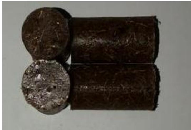
Gambar 4.1. Spesimen TKKS dan Filter Rokok dengan Komposisi A
