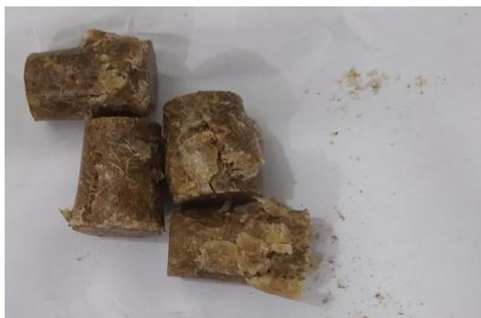
Gambar 4.10. Spesimen Setelah di uji Tekan Pada komposisi B
