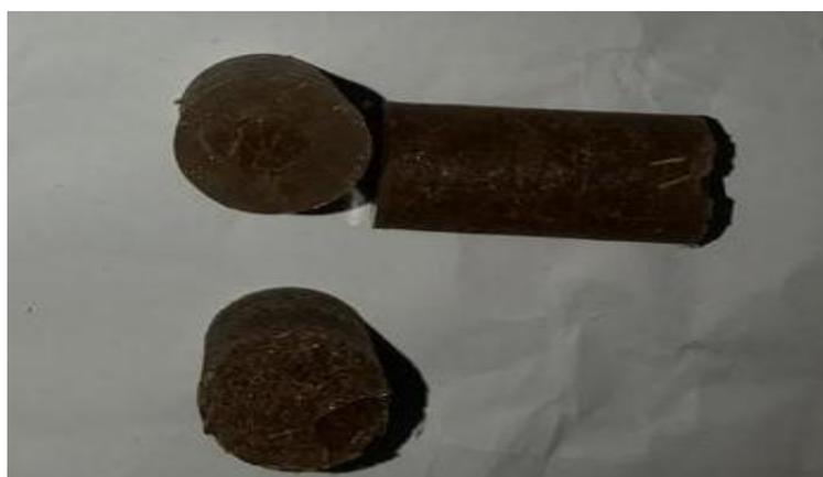
Gambar 4.4. Spesimen TKKS dan Filter Rokok dengan Komposisi D
