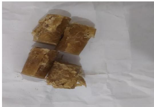
Gambar 4.12. Spesimen setelah di uji Tekan pada spesimen D
