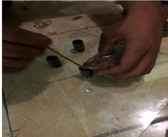
Gambar 3.1. cetakan Spesimen Uji tekan
