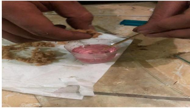
Gambar 3.21. Memasukkan Serat ke Resin
