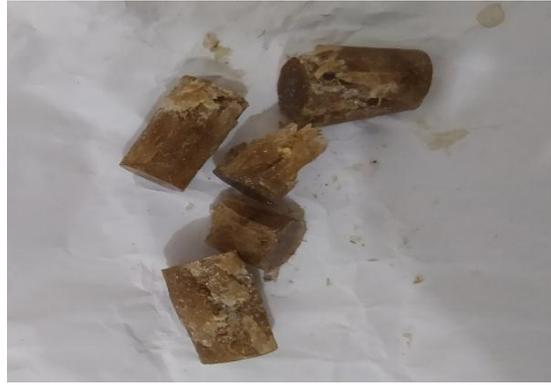
Gambar 4.11. Spesimen Setelah di uji Tekan pada komposisi C
