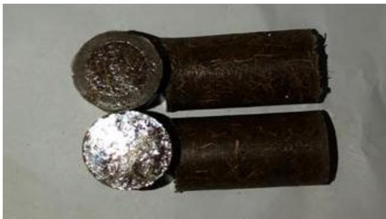
Gambar 4.2. Spesimen TKKS dan Filter Rokok dengan komposisi B
