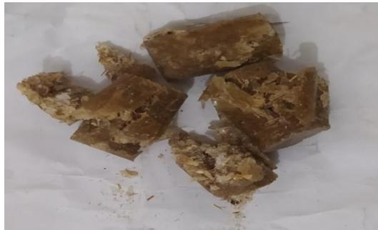
Gambar 4.9. Spesimen Setelah Di uji Tekan Pada Komposisi A
