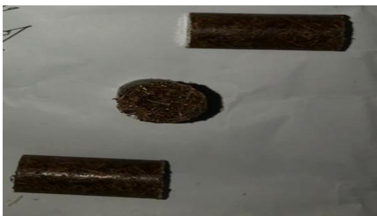
Gambar 4.3. Spesimen TKKS dan Filter Rokok dengan Komposisi C
