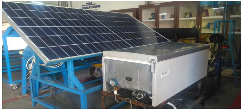
Gambar 4.3. Pengujian pengaruh arah sudut matahari terhadap keluaran sel surya arah sinar membentuk sudut 40 derajat.
