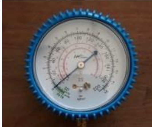
Gambar 4.1. Manifold meter sebagai alat mengukur data tekanan.
