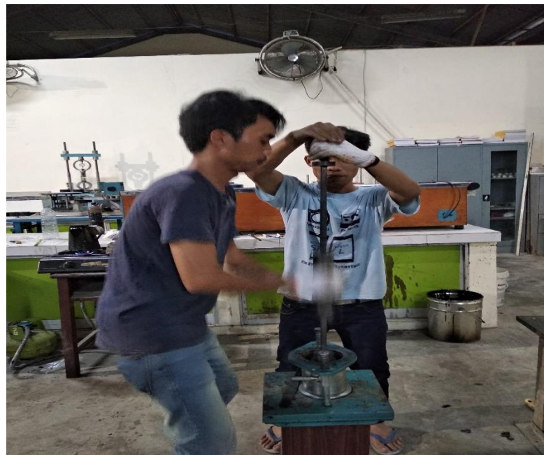
L.Gambar 20: Proses Pembuatan Benda Uji.
