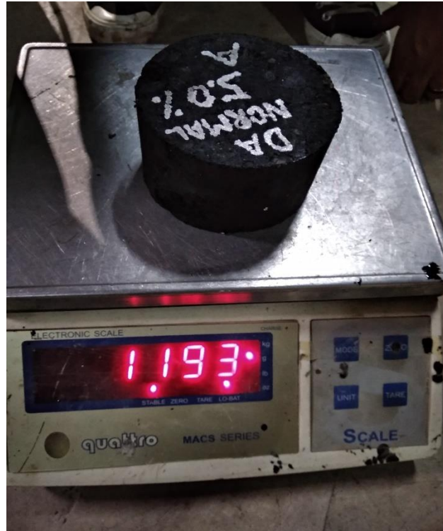
L.Gambar 21: Penimbangan Benda Uji.
