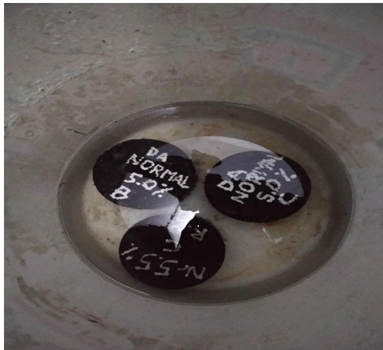
L.Gambar 22: Perendaman Benda Uji.
