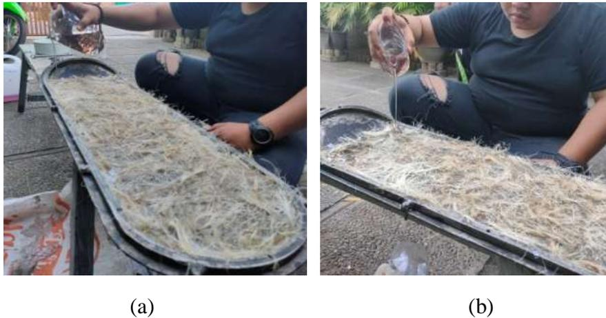
Gambar 4.15 (a) Penuangan Resin Kedalam Cetakan (b) Perataan Resin Kedalam Cetakan
