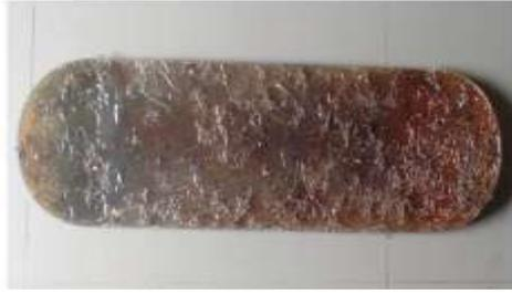
Gambar 2.17 Hasil Pembuatan Skateboard Dengan Cetakan Terbuka
