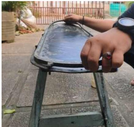
Gambar 4.6 Pemasangan Cetakan Tengah Skate
