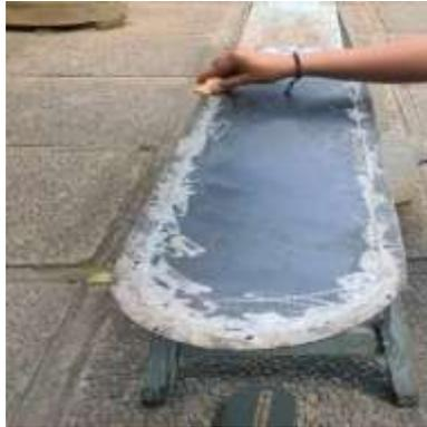
Gambar 4.5 Proses Pemberian Wax Pada Cetakan Papan
