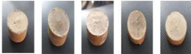
Gambar 2.13 komposit dengan komposisi styrofoam:serbuk ijuk aren(Aprilina Purbasari,dkk,2019)
