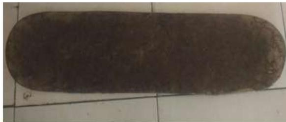
Gambar 2.19 Hasil Pembuatan Skateboard Dengan Cetakan Terbuka(
