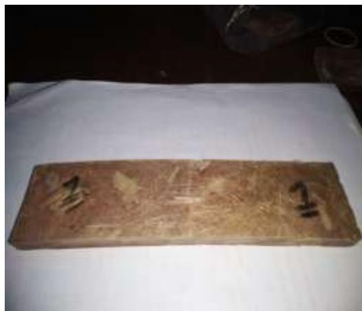
Gambar4.1 Hasil Pengujian Spesimen Uji *Bending*97% Resin : 3% Serat
