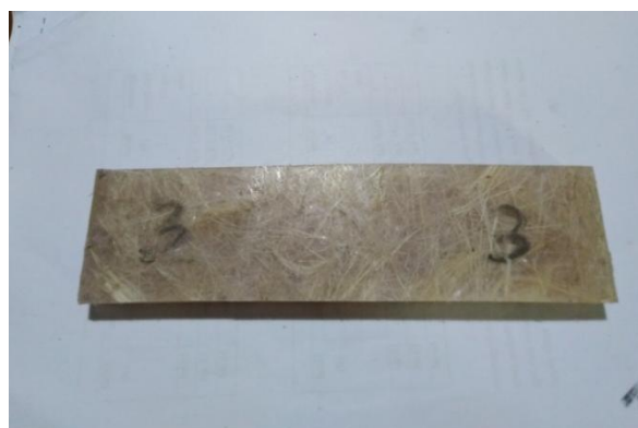
Gambar 3.11 Spesimen Uji Bending 95% Resin : 5% Serat
