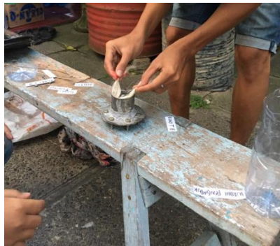
Gambar 2.25 Proses Penyusunan Serat Daun Nanas ke dalam Cetakan Roda
