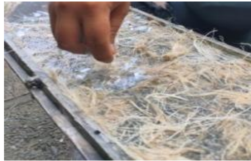
Gambar 3.21 Proses Penyusunan Serat Daun Nanas ke dalam Cetakan Papan Skateboard
