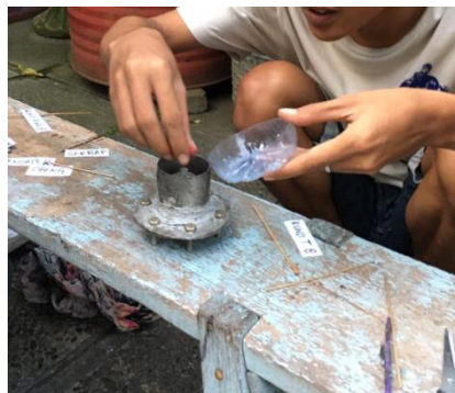
Gambar 2.25 Proses Penyusunan Limbah botol Plastik ke dalam Cetakan Roda
