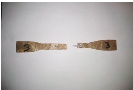
Gambar 4.3 Hasil Pengujian Tarik 95% Resin : 5% Serat
