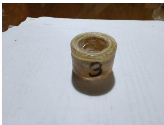
Gambar 3.15 Spesimen Uji Tekan 95% Resin : 5% Serat
