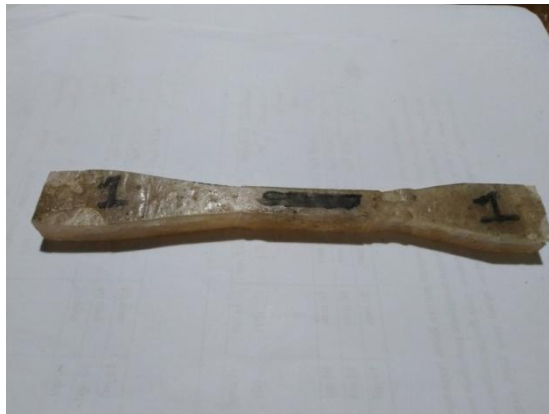
Gambar 3.5 Spesimen Uji Tarik 97% Resin : 3% Serat
