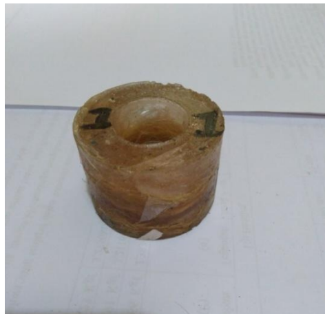
Gambar4.11 Hasil Pengujian Spesimen Uji Tekan 97% Resin : 3% Serat
