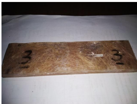
Gambar 4.9 Hasil Pengujian Spesimen Uji Bending 95% Resin : 5% Serat
