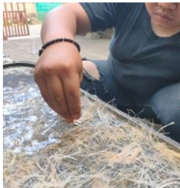
Gambar 3.22 Proses Penyusunan Limbah Botol Plastik ke dalam Cetakan Skateboard
