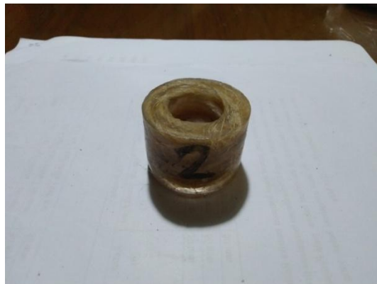
Gambar 3.14 Spesimen Uji Tekan 96% Resin : 4% Serat
