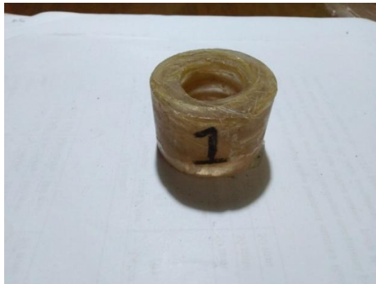
Gambar 3.13 Spesimen Uji Tekan 97% Resin : 3% Serat
