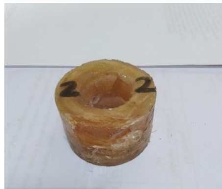
Gambar 4.12 Hasil Pengujian Spesimen Uji Tekan 96% Resin : 4% Serat
