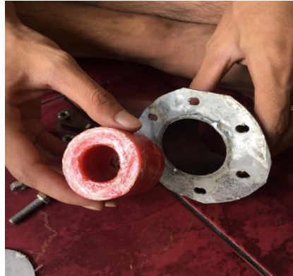
Gambar 2.26 Proses Pelepasan Spesimen dari Cetakan Roda
