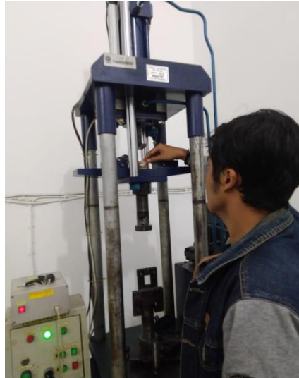
Gambar 2.29 Proses Pemasangan Spesimen Tekan
