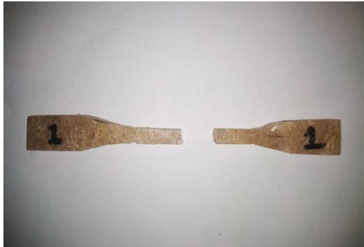
Gambar 4.1 Hasil Pengujian Tarik 97% Resin : 3% Serat
