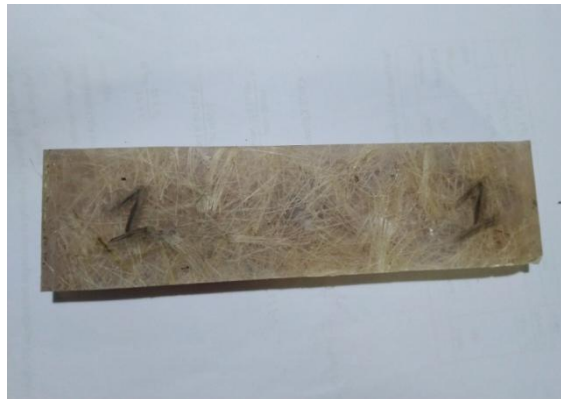
Gambar 3.9 Spesimen Uji Bending 97% Resin : 3% Serat
