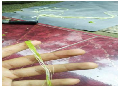
Gambar 3.18 Serat Daun Nanas Setelah Pengerokan ( Scraping )
