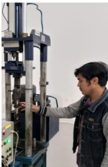
Gambar 2.27 Proses Pemasangan Spesimen Tarik
