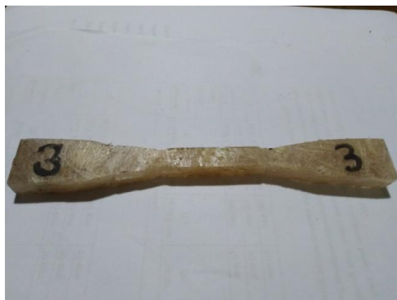
Gambar 3.7 Spesimen Uji Tarik 95% Resin : 5% Serat
