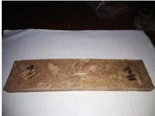
Gambar 4.7 Hasil Pengujian Spesimen Uji Bending 97% Resin : 3% Serat
