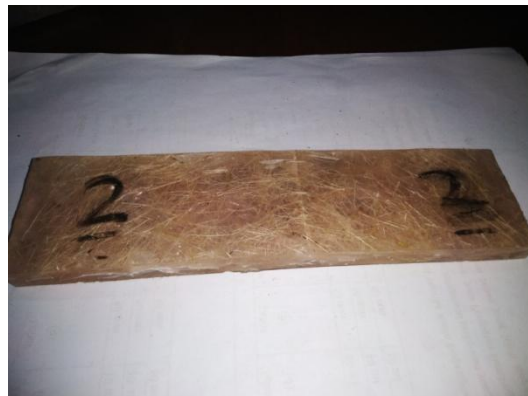
Gambar 4.8 Hasil Pengujian Spesimen Uji Bending 96% Resin : 4% Serat
