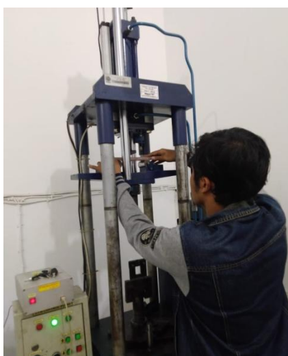
Gambar 2.28 Proses Pemasangan Spesimen Bending
