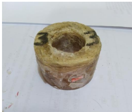
Gambar 4.13 Hasil Pengujian Spesimen Uji Tekan 95% Resin : 5% Serat
