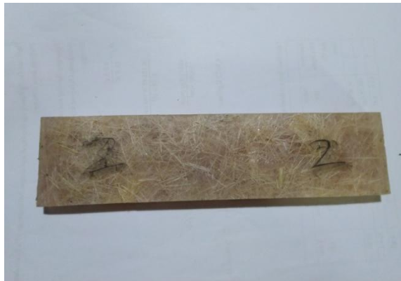
Gambar 3.10 Spesimen Uji Bending 96% Resin : 4% Serat
