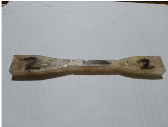
Gambar 3.6 Spesimen Uji Tarik 96% Resin: 4% Serat
