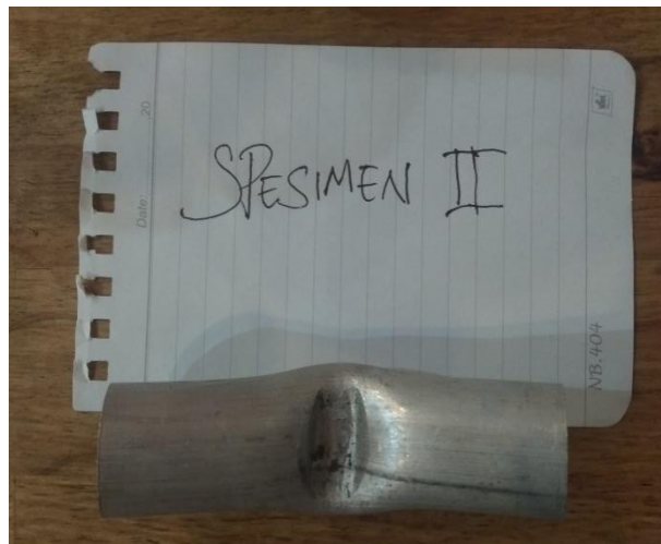
Gambar 4.8 Spesimen dengan diameter 16,5 mm dengan tebal 3,5 mm
