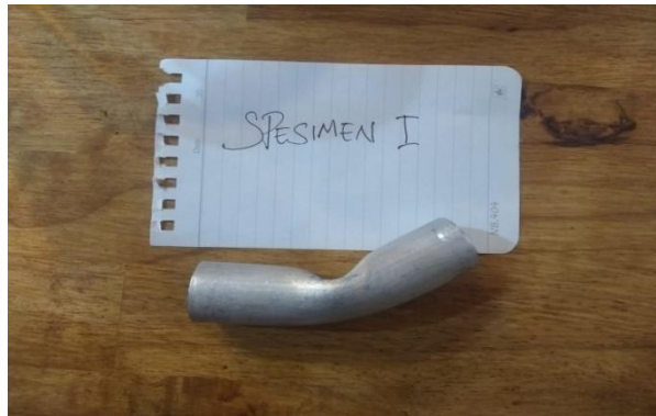
Gambar 4.7 Spesimen dengan diameter 16,5 mm dengan tebal 3,5 mm
