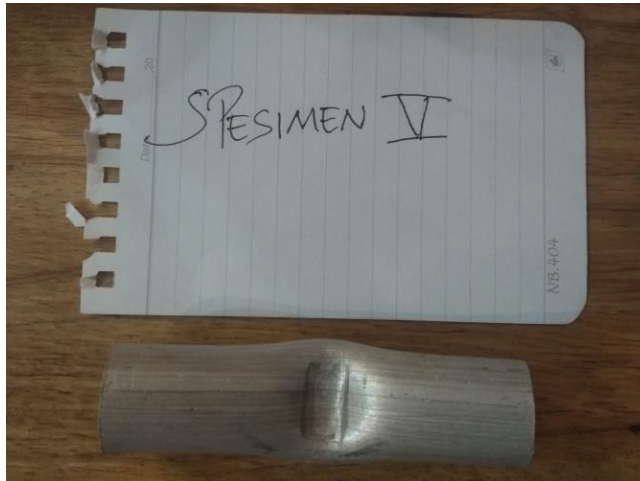
Gambar 4.11 Spesimen dengan diameter 17 mm dengan tebal 3 m
