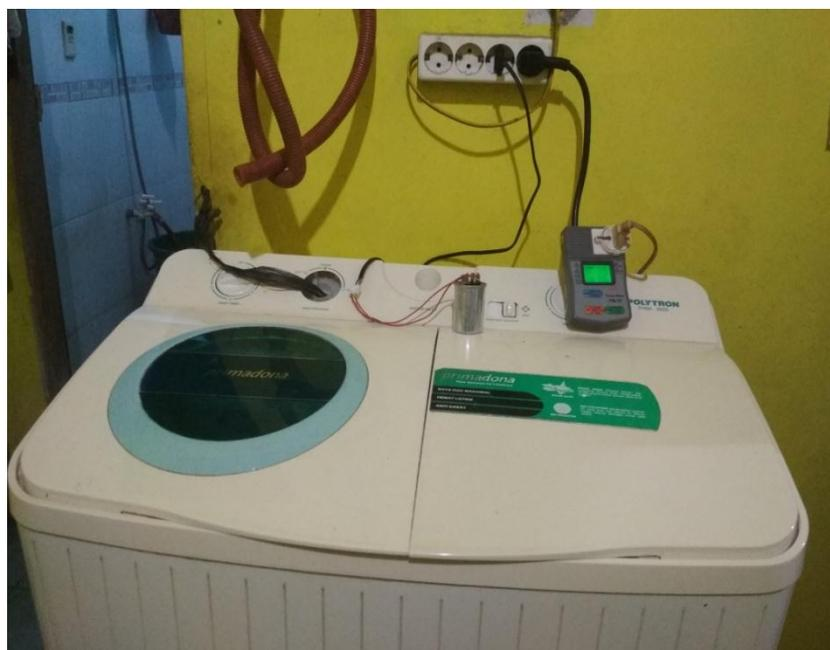
Pemasangan Kapasitor Bank Pada Mesin Cuci 2 Tabung
