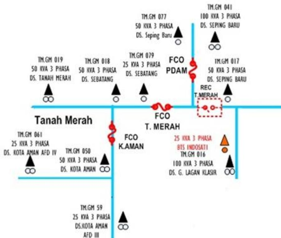
**Gambar 4.1 Single Line Diagram Jaringan Radial PK. Tanah Merah**
