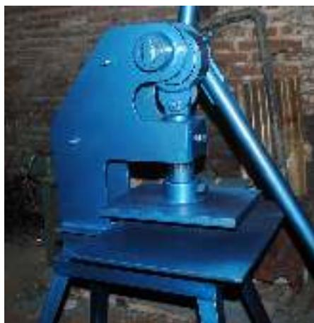
Gambar 2.1 Mesin *punch* tenaga manual
