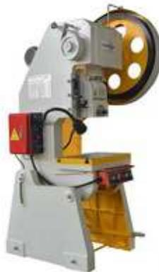
Gambar 2.3 Mesin *punch* mekanikal
