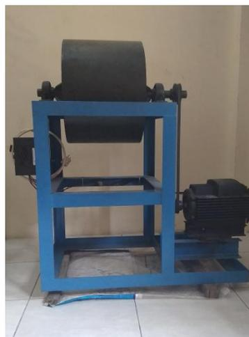
Gambar 4.24. Hasil Dari Desain Mesin *Ball Mill* Yang Telah Dibuat
