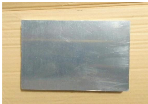
Gambar 2.12. Heatsink terbuat dari bahan aluminium.
