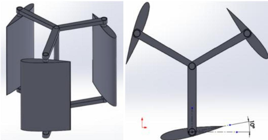
Gambar 4.11 Sudu 3 turbin *Darrieus* Dengan Sudut Serang  $10^{\circ}$
