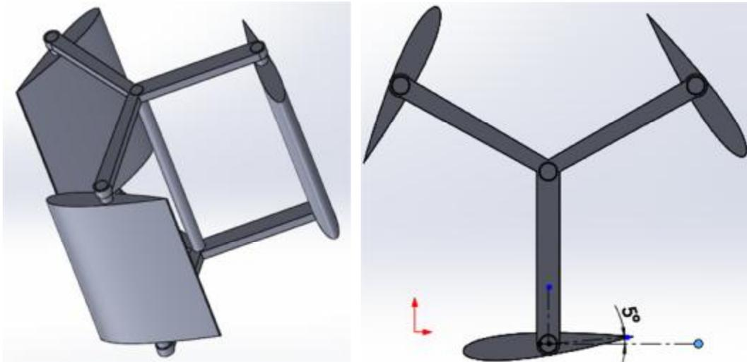
Gambar 4.10 Sudu 3 Turbin *Darrieus* Dengan Sudut Serang  $5^{\circ}$
