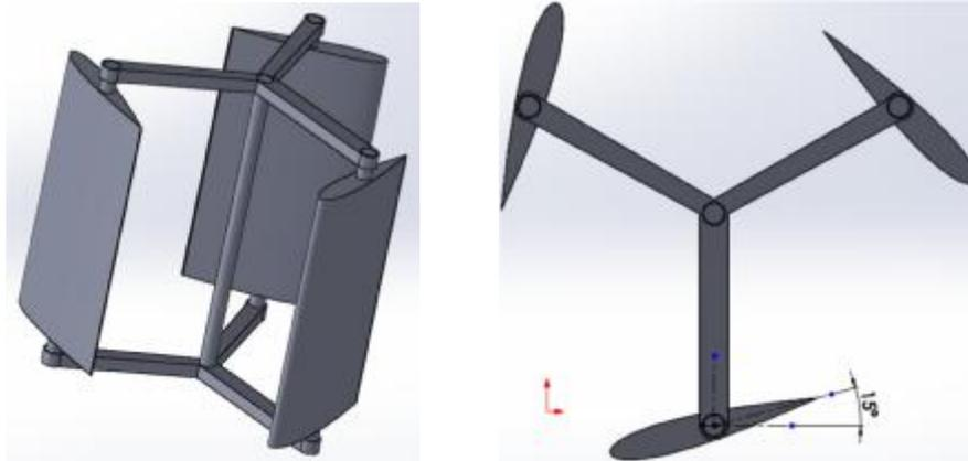
Gambar 4.12 Sudu 3 turbin *Darrieus* Dengan Sudut Serang 15<sup>0</sup>
