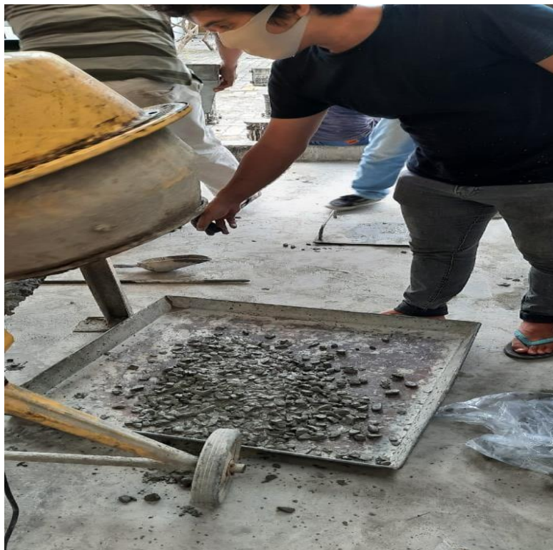
GAMBAR L4: DOKUMENTASI PROSES PENGECORAN PEMBUATAN BENDA UJI PENELITIAN
