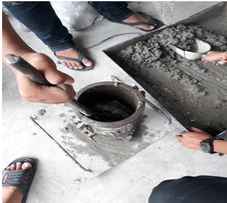
GAMBAR L6: DOKUMENTASI PROSES PENCETAKAN BENDA UJI PENELITIAN
