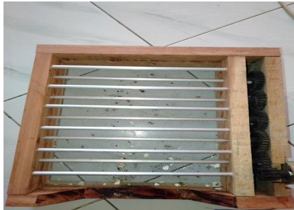
Gambar 3.12 Pemasangan gear motor
