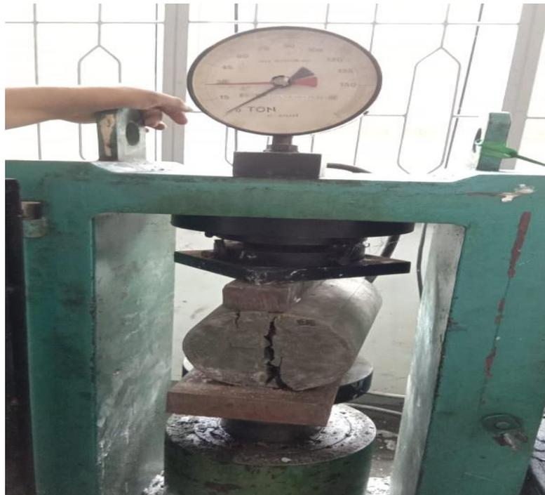
Gambar L9: Dokumentasi pengujian kuat tarik belah beton.
