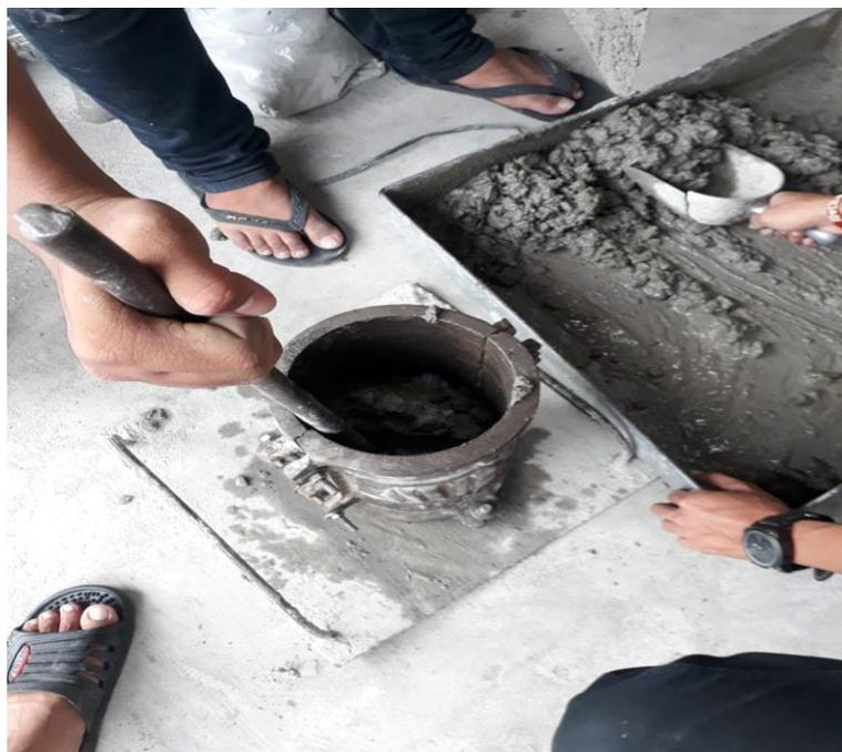
Gambar L6: Dokumentasi proses pencetakan benda uji penelitian.
