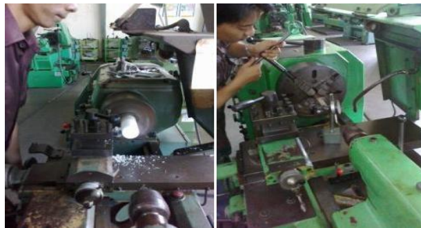
Gambar 4.11 proses pembuatan pulley
