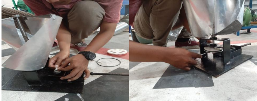
Gambar 4.20 perakitan benda kerja menggunakan pulley Dengan menggunakan sudu type helix
