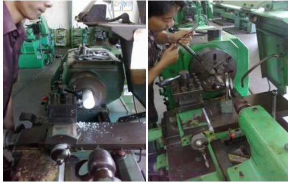
Gambar 4.4 proses pembubutan roda gigi
