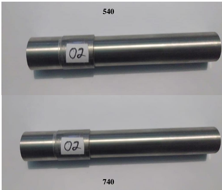
Gambar 4.12 Spesimen 0,2 mm kedalaman penggerindaan pada kecepatan putaran spindle 540 rpm dan 740 rpm.
