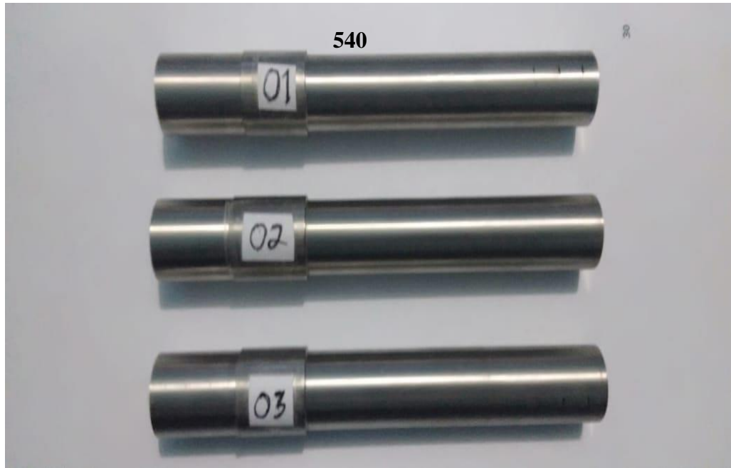
Gambar 4.16 Spesimen 0,1 mm, 0,2 mm, 0,3 mm, kedalaman penggerindaan pada kecepatan putaran spindle 540 rpm.
