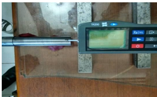
Gambar 4.9 Pengujian Material Stainless 304 Dengan Menggunakan Roughness Tester
