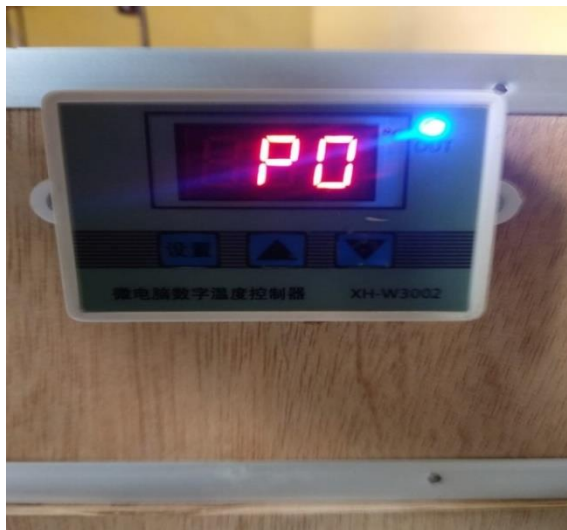
Gambar 3.9 Menyetel thermostat untuk mengatur suhu
