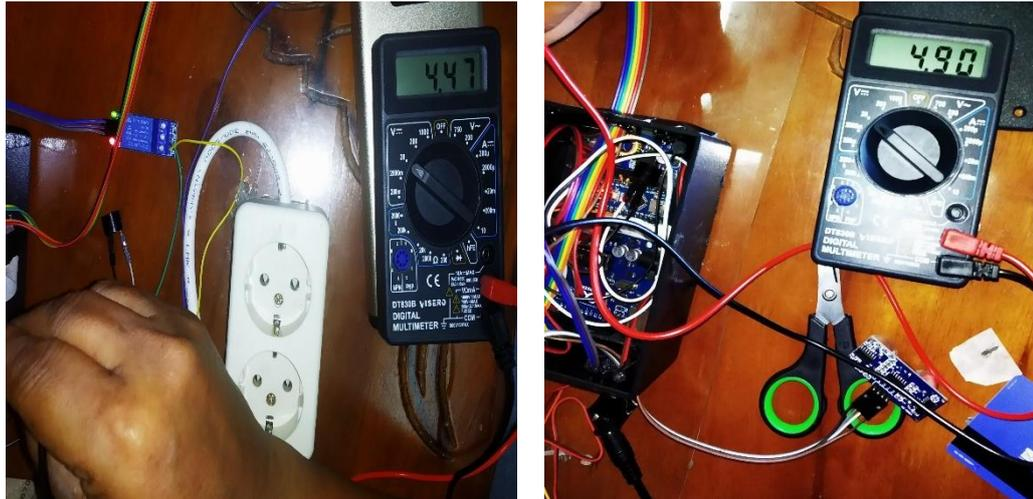
**Gambar 4.2 (a) Pengujian Power Supplay 5 VDC (b) Pengujian Power Supplay 12 DC**
