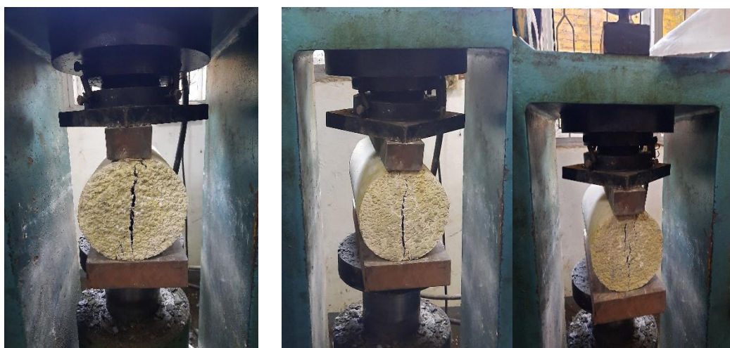
Gambar L.26: Pengujian Kuat Tarik Belah BS 5%.
