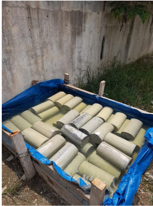
Gambar L.21: Perendaman Benda Uji.
