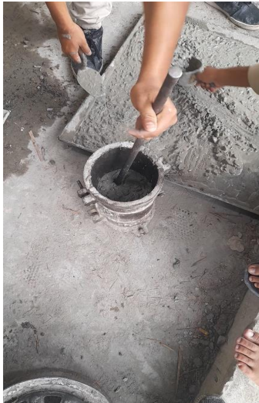
Gambar L.18: Perojokan Adukan Beton di Cetakan.
