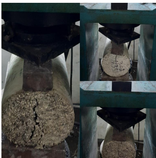
Gambar L.30: Pengujian Kuat Tarik Belah BS 7%.
