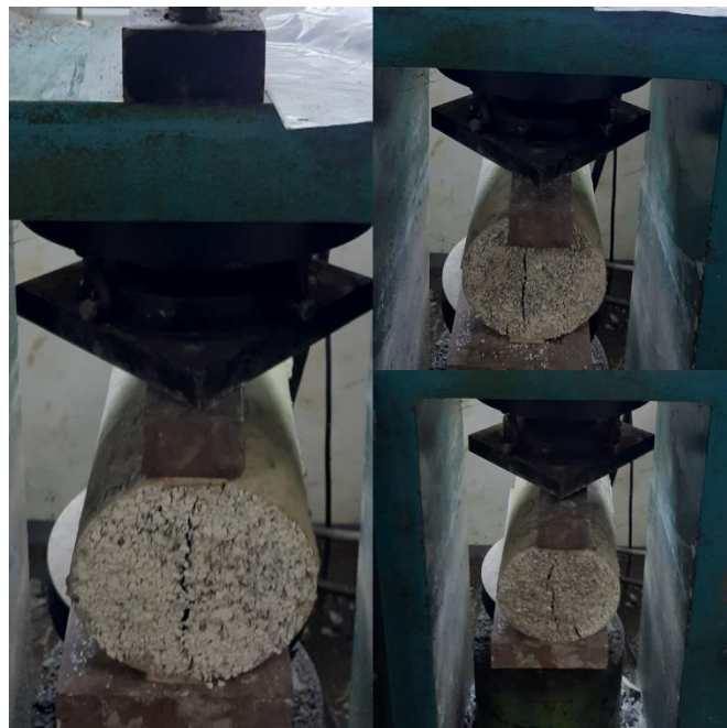
Gambar L.28: Pengujian Kuat Tarik Belah BS 6%.
