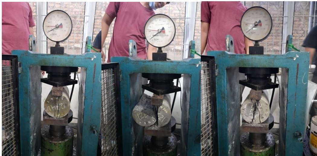
Gambar L.24: Pengujian Kuat Tarik Belah BN.
