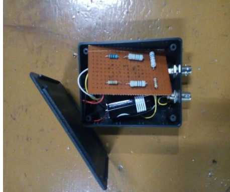
Gambar 3.26 Pemasangan Bridge Box
