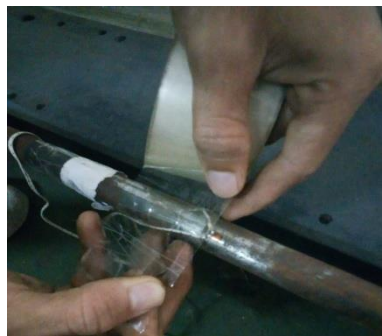
Gambar 3.24 Pemasangan Strain Gages
