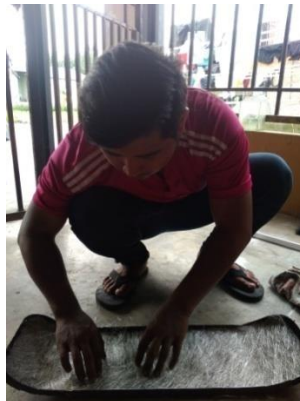
Gambar. 3.17. mempersiapkan fiber glass
