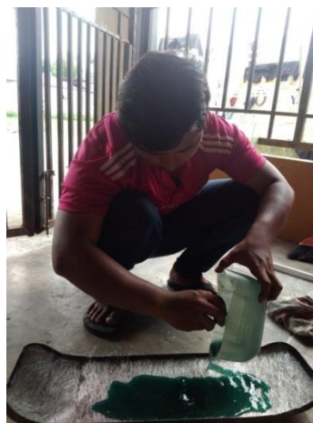
Gambar. 3.18. Penuangan resin dan katalis.
