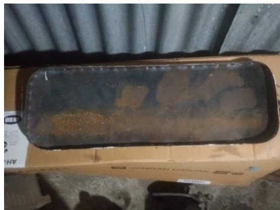
Gambar 3.15 mempersiapkan cetakan papan skateboard
