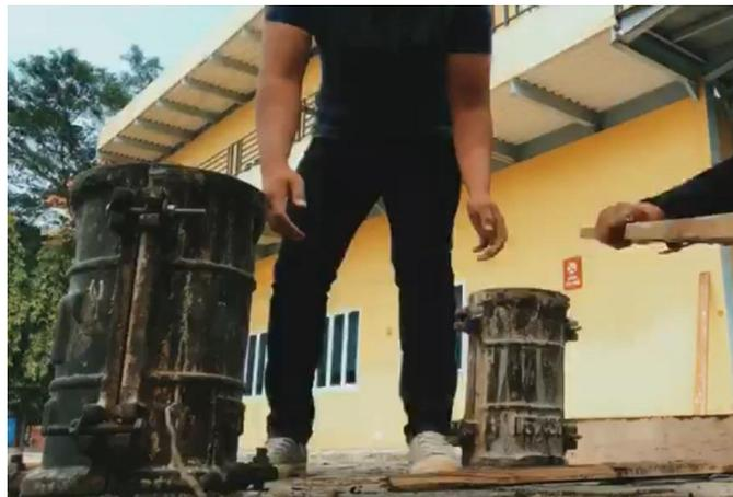
Gambar 3.5: Proses pemadatan benda uji.
