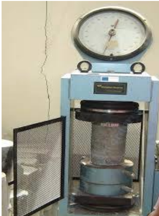
Gambar 4.5: Kuat tekan pada benda uji.
