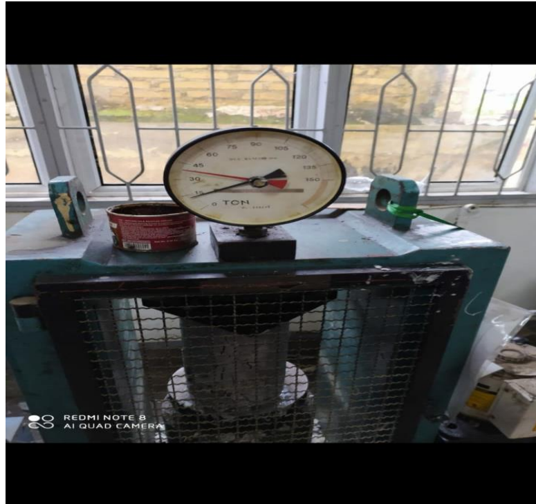
Gambar L9: Dokumentasi pengujian kuat tekan beton
