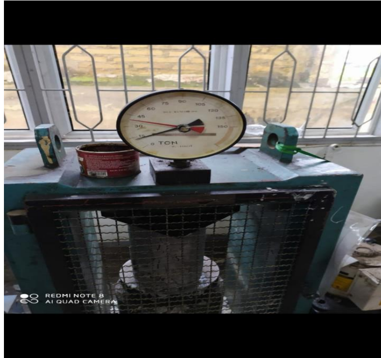
Gambar L9: Dokumentasi pengujian kuat tekan beton
