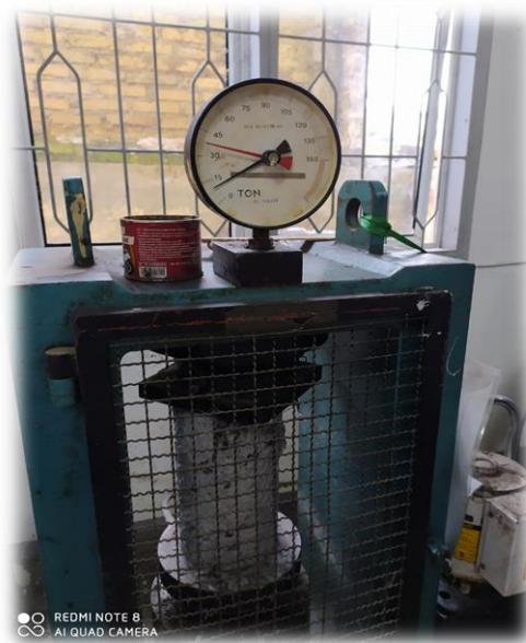
Gambar 4.5 : Pengujian Kuat tekan pada benda uji Silinder.
