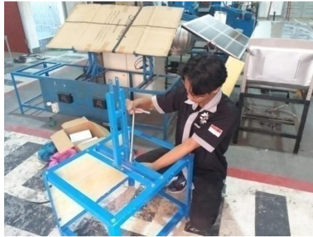
Gambar 3.23 Memasang Tiang Panel
