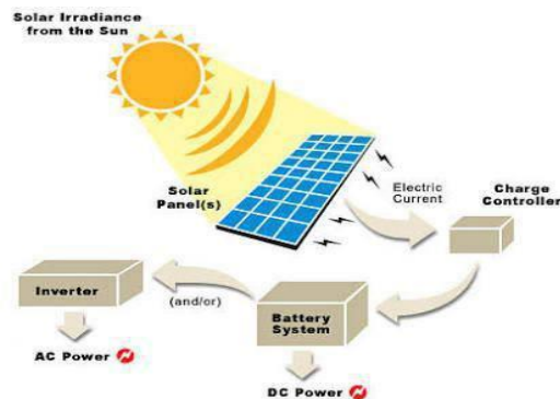
Gambar 2.5 Prinsip Kerja Sel Surya (Anggara Bayu, 2019)
