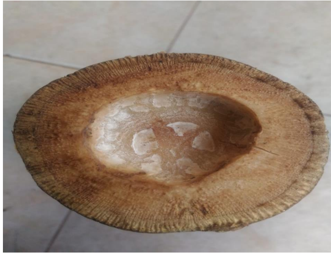
Gambar 4.2 Spesimen batang pepaya sebelum diuji
