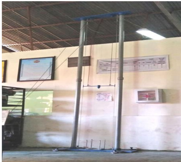
Gambar 3.4 Mesin Uji Gerak Jatuh Bebas
