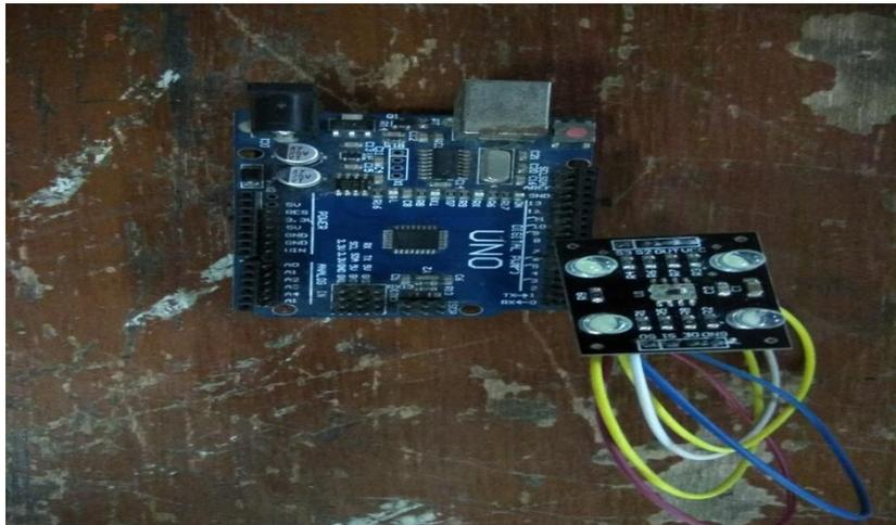
Gambar 3.19 rangkaian arduino ke sensor warna TCS3200
