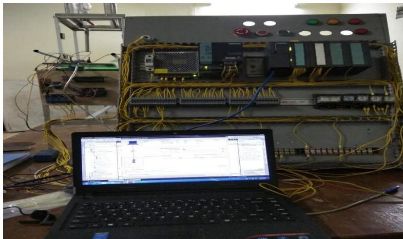
Gambar 4.1 Hasil perancangan penyortir barang berdasarkan warna
