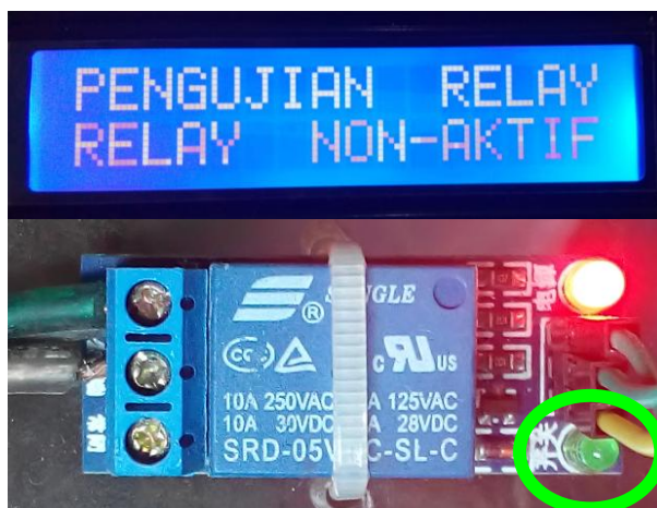
Gambar 4.11 Hasil Pengujian Saat Relay Non-Aktif
