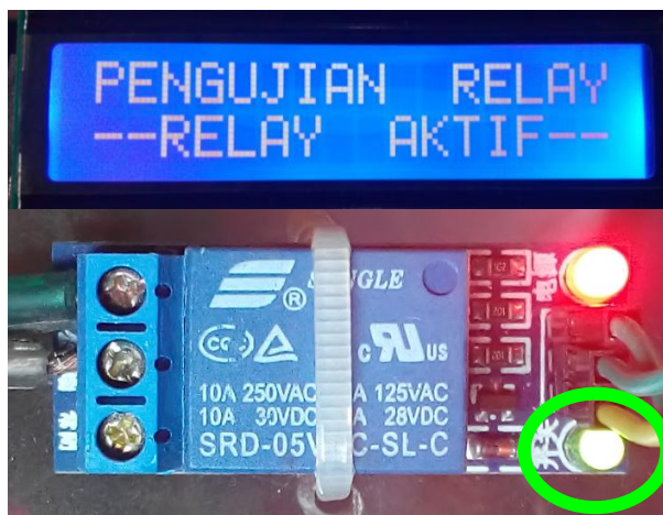
Gambar 4.10 Hasil Pengujian Saat Relay Aktif
