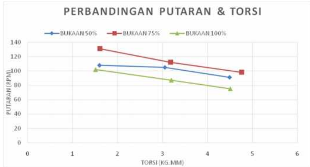
Gambar 4.3 Grafik Putaran dan Torsi dengan beban 50, 100, dan 150 gram
