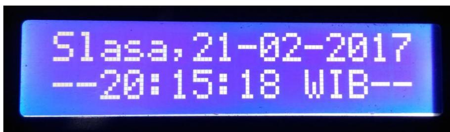
Gambar 4.18 Hasil Pembacaan Rangkaian RTC ditampilkan pada LCD
