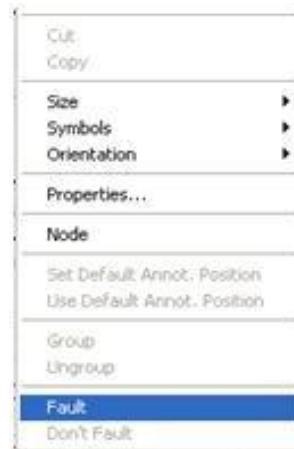
Gambar 2.28. Toolbar Short Circuit Di ETAP
