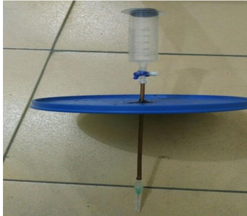
Gambar 4.8 Proses pengeleman jarum tinta
