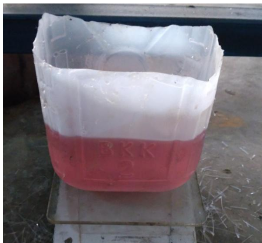
Gambar 3.21 Mencampurkan polyester resin,serat plastik dengan katalis
