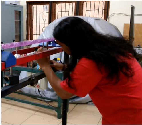
Gambar 3.31 Merakit Uji Lendutan
