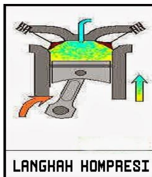
Gambar 2.7 Langkah kompresi mesin 4 tak
