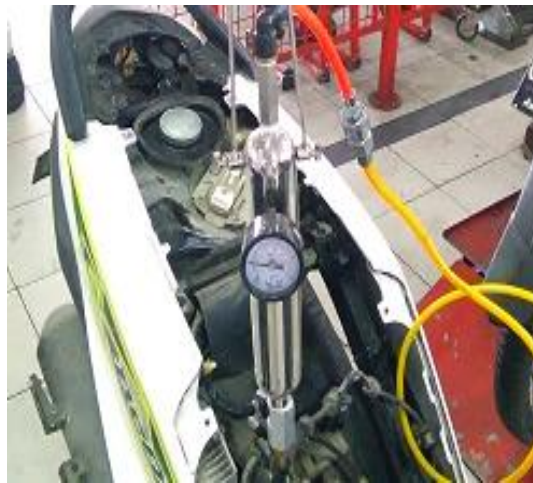
Gambar 2.14 Proses menggunakan alat flash injector
