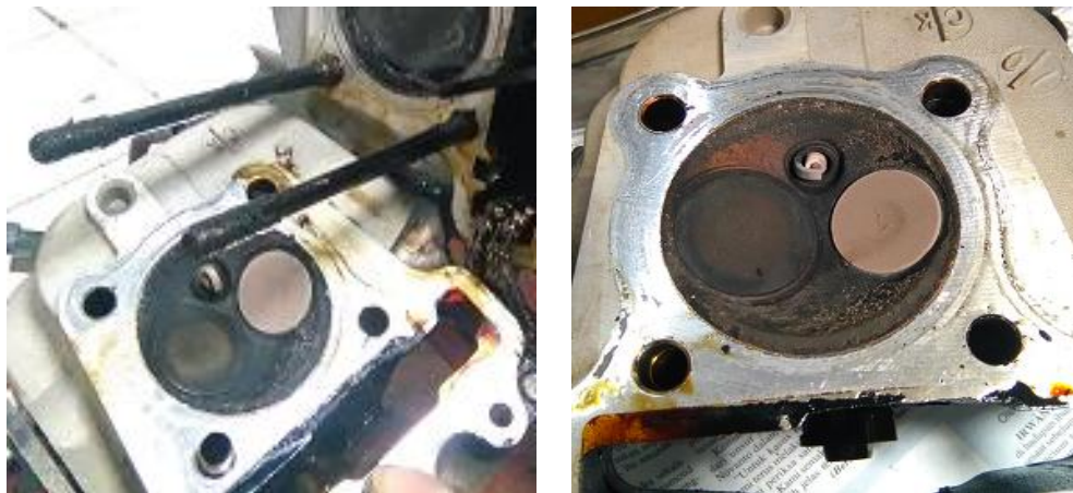
Gambar 3.20. Kondisi klep Sebelum Dan Sesudah Menggunakan alat flash injector .
