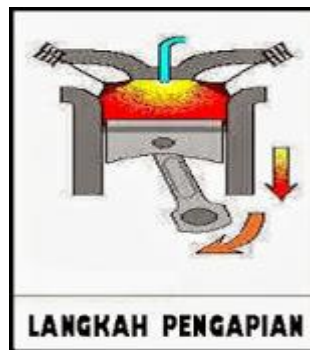
Gambar 2.8 Langkah usaha (pengapian) mesin 4 tak
