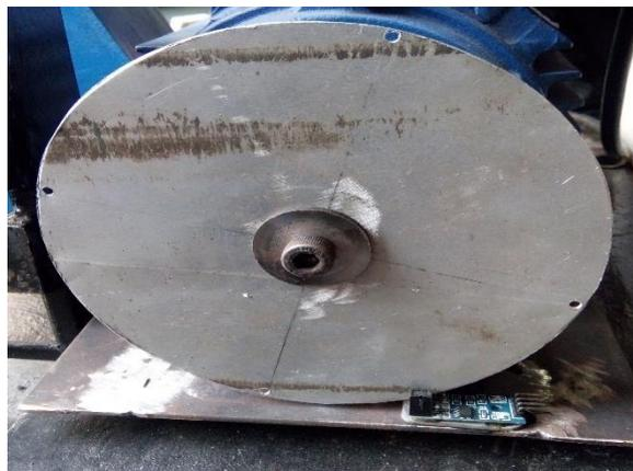
Gambar 3.10. Sensor Kecepatan
