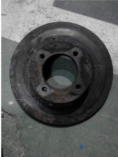
Gambar 3.22. Spesimen/Cakram Rem Mobil
