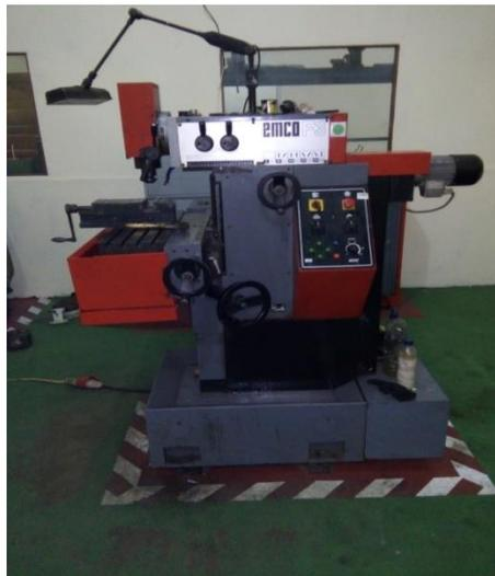
Gambar 3.12. Mesin Frais ( *Milling* )
