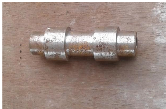
Gambar 4.2. Poros engkol yang telah di bubut
