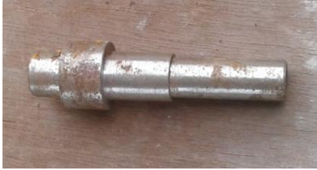
Gambar 4.3. Poros engkol yang telah di bubut
