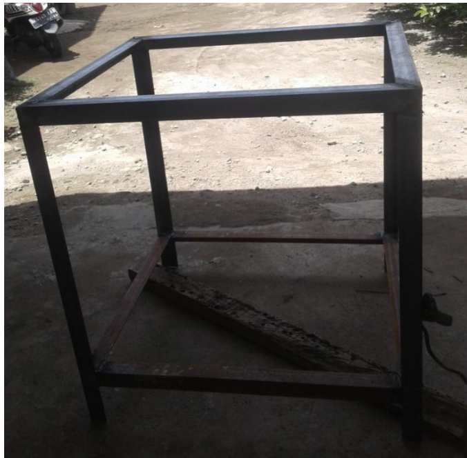
Gambar 4.6. pengelasan perakitan rangka atas, bawah, dan tegak ( kaki ).
