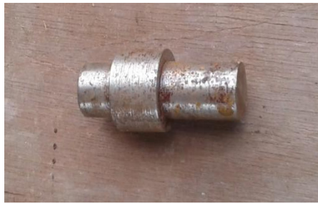
Gambar 4.1. Poros engkol yang telah di bubut
