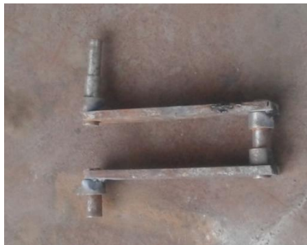
Gambar 4.7. Pengelasan pada tuas penekan pada hidrolik
