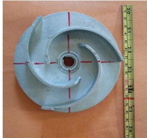
**Lampiran 3 Gambar impeller dengan panjang sudu 130 mm.**
