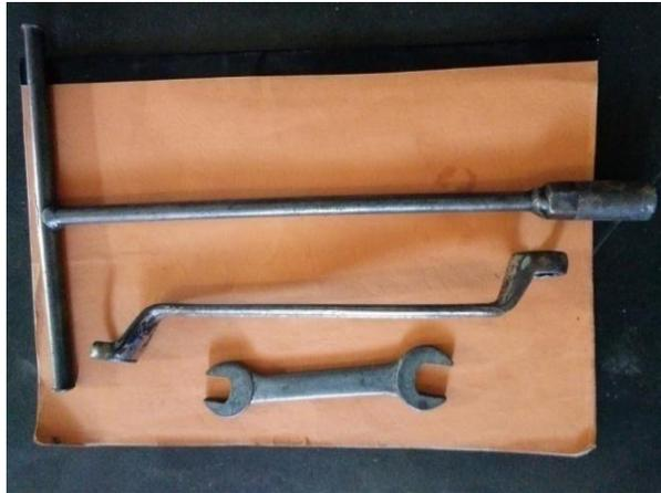
Gambar 3.15. Kunci-Kunci untuk membuka impeller dan rumah impeller
