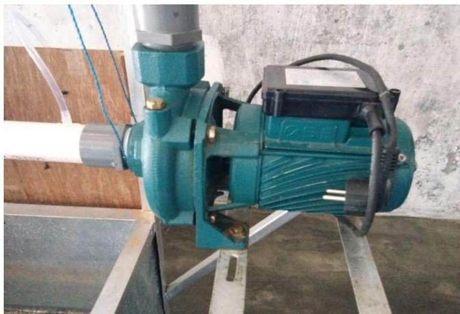
Gambar 3.4. Pompa Sentrifugal
