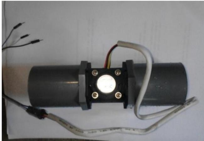
Gambar 3.7. Flow Meter Sensor
