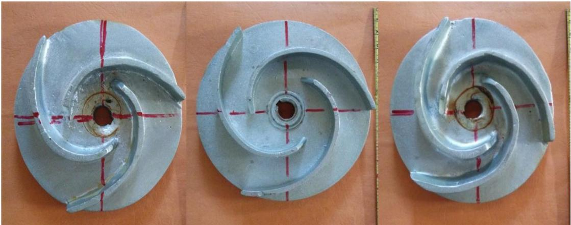
Gambar 3.9. Tiga Impeller dengan panjang sudu 110 mm, 120 mm dan 130 mm
