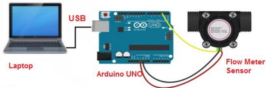
Gambar 3.17. Skema rangkaian Flow meter sensor
