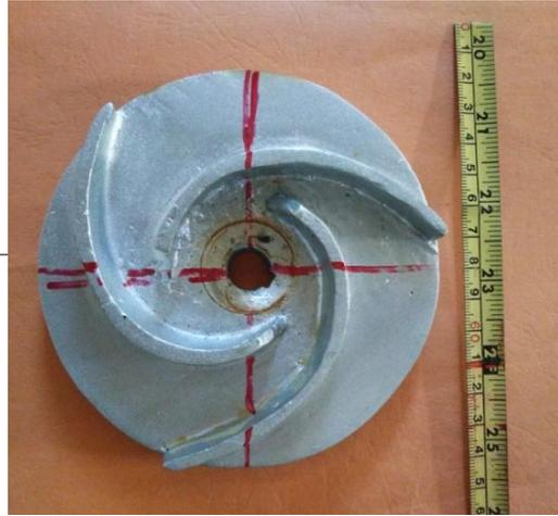
**Lampiran 2 Gambar impeller dengan panjang sudu 120 mm.**
