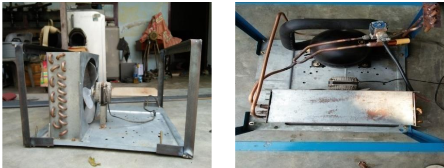
Gambar 4.3 Hasil Perakitan Kompresor Dengan Kondeser
