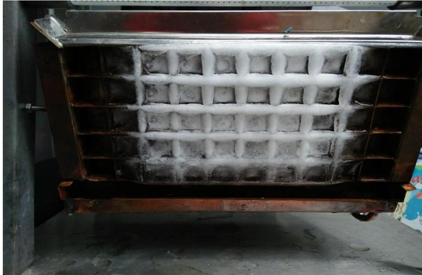
**Gambar 3.29 Hasil Akhir Evaporator Pada Es Kubus setelah diuji**
