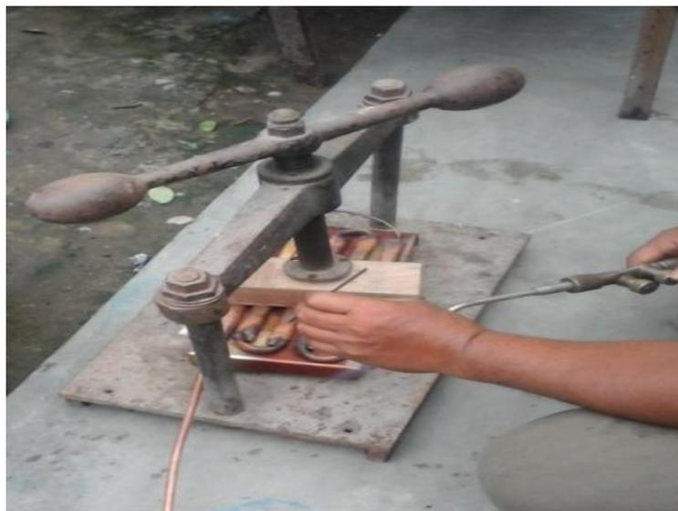
Gambar 4.4 pengepresan dan pengelasan pipa tembaga pada plat
