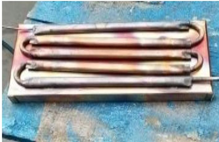
Gambar 4.2 hasil evaporator pada saat dibuat
