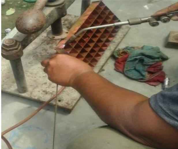
**Gambar 3.27 Pengelasan Kotak-Kotak Evaporator**
