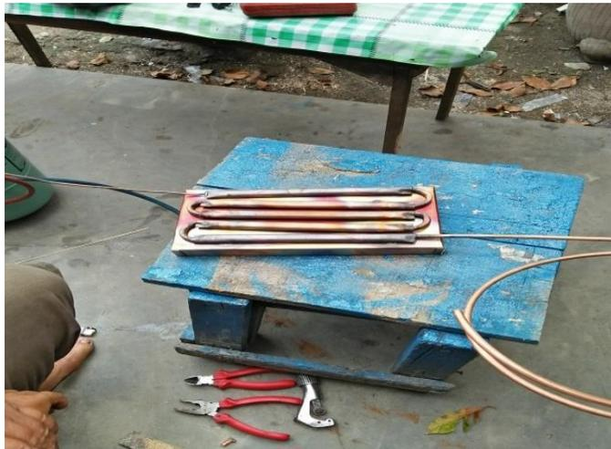
**Gambar 3.26 Hasil Lasan Pipa Pada Pelat**
