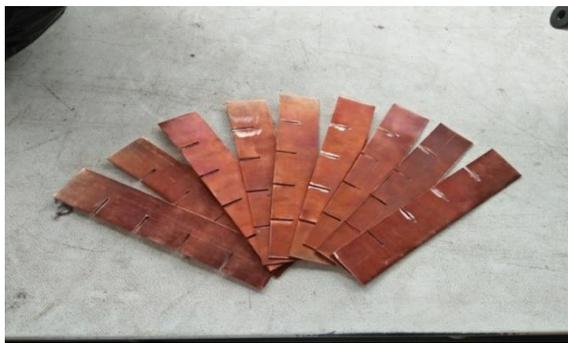
**Gambar 3.6 Plat Tembaga untuk pembuatan evaporator**
