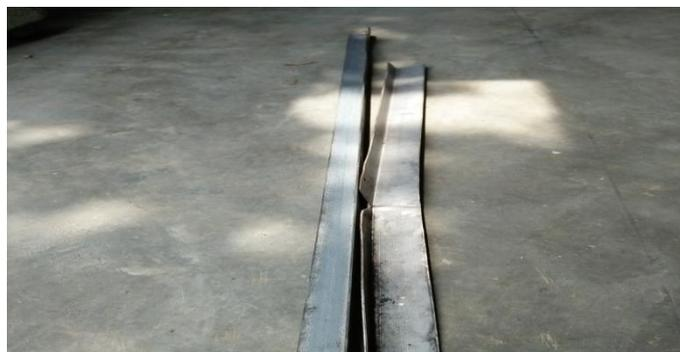
**Gambar 3.7 Besi Siku Untuk Konstruksi Rangka**
