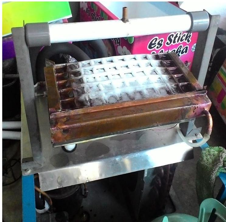
Gambar 4.8 Hasil Pembuatan evaporator Mesin Kubus Es Berukuran Kecil.
