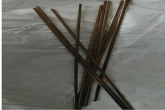
**Gambar 3.4 Elektroda Las**
