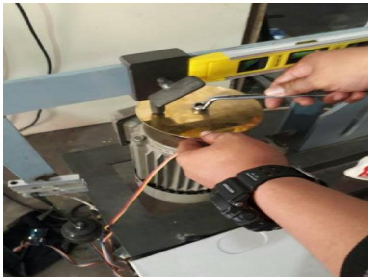
**Gambar 3.11** Pemasangan Spesimen
