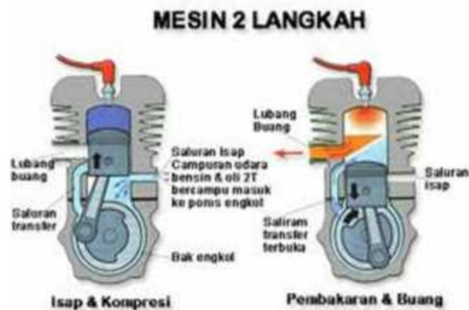
Gambar 2.3 : Prinsip kerja motor 2 langkah
