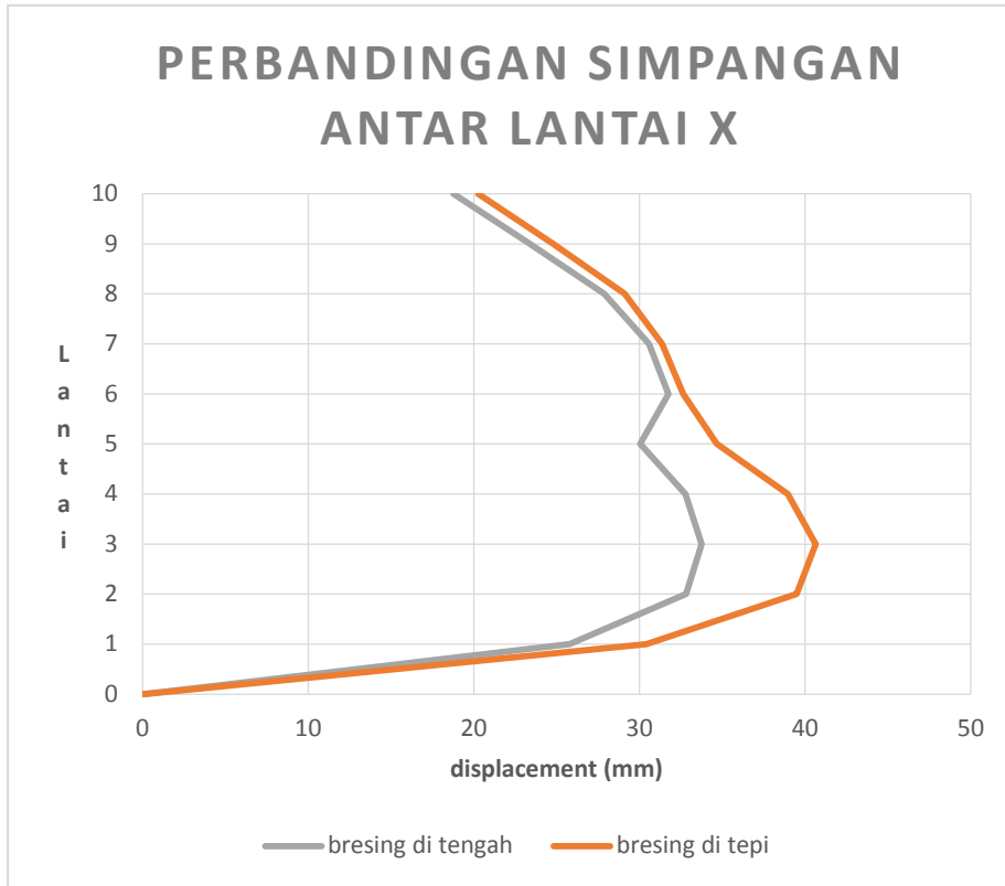
Gambar 4.4: Perbandingan simpangan antar lantai pada arah X.
