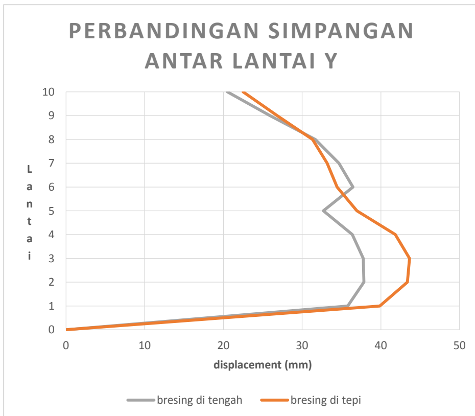
Gambar 4.5: Perbandingan simpangan antar lantai pada arah Y.
