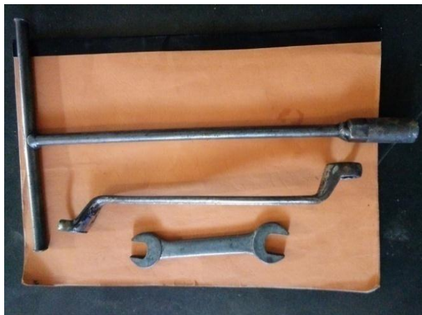
Gambar 3.15. Kunci-Kunci untuk membuka impeller dan rumah impeller
