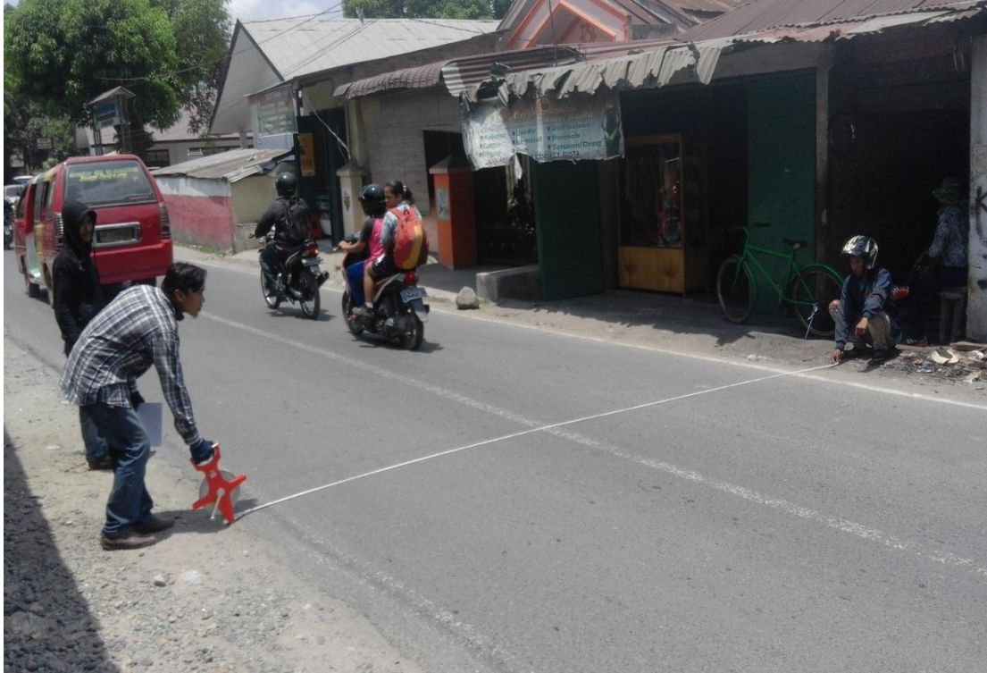
Gambar L.2.5: Pengukuran lebar badan jalan di Jalan Klambir 5.
