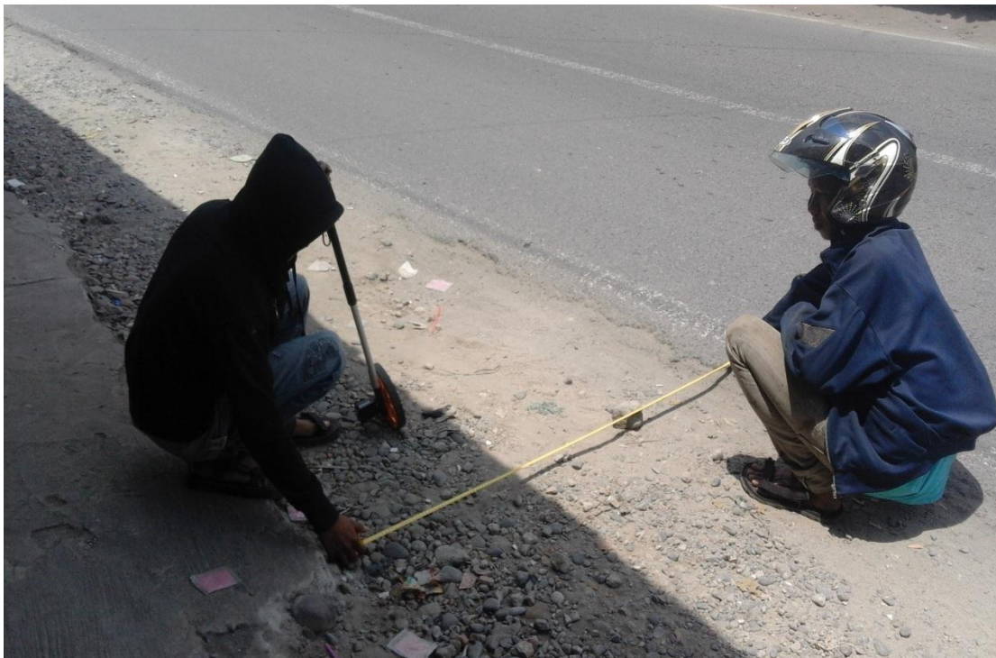
Gambar L.2.4: Pengukuran bahu jalan di Jalan Klambir 5.
