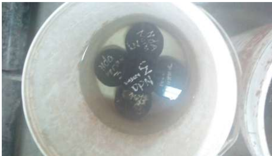
Gambar L12: Proses perendaman benda uji.
