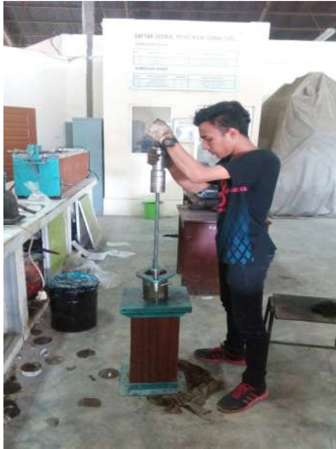
Gambar L9: Proses penumbukan benda uji.
