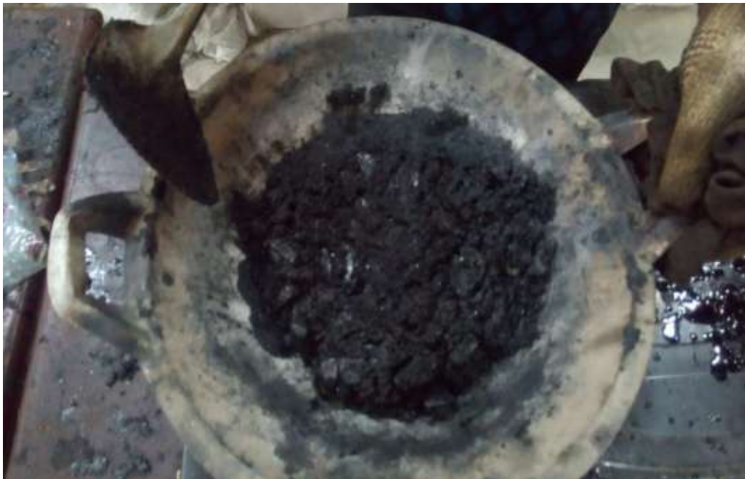
Gambar L8: Proses pencampuran aspal terhadap agregat.
