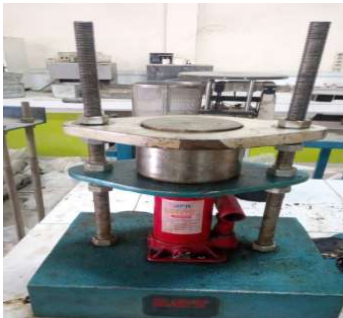
Gambar L10: Alat untuk mengeluarkan benda uji dari cetakan.
