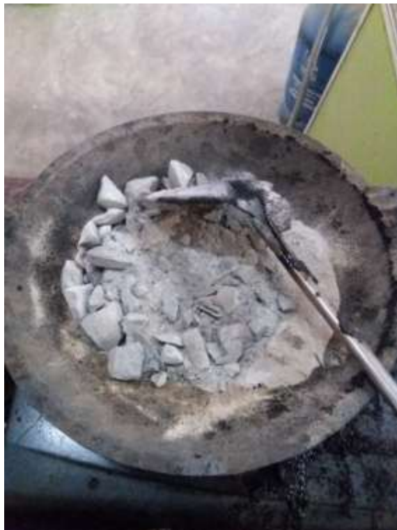
Gambar L6: Proses pencampuran agregat menggunakan filler limbah karbit.
