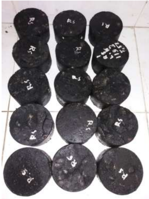
Gambar L13: Benda uji menggunakan filler limbah karbit.
