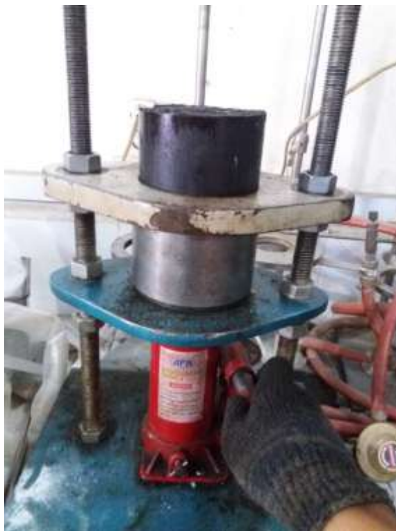
Gambar L10: Proses pengeluaran benda uji setelah dipadatkan dengan alat extruder .
