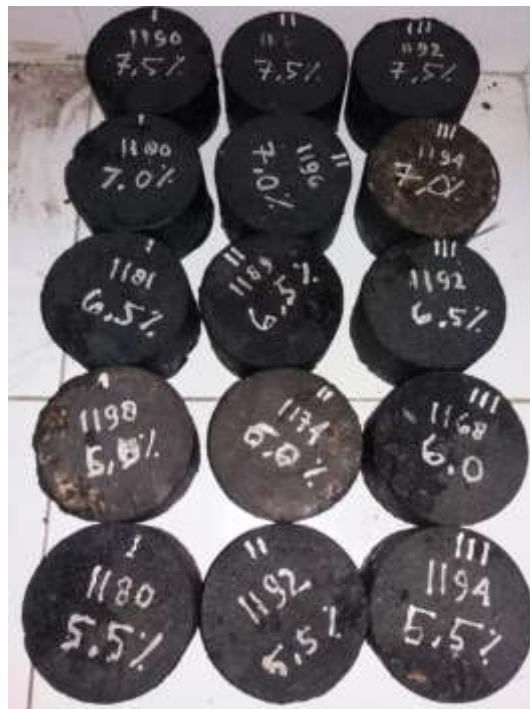
Gambar L12: Benda uji menggunakan filler abu batu.
