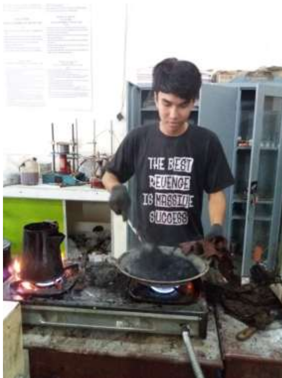
Gambar L8: Proses pemanasan agregat dan aspal.
