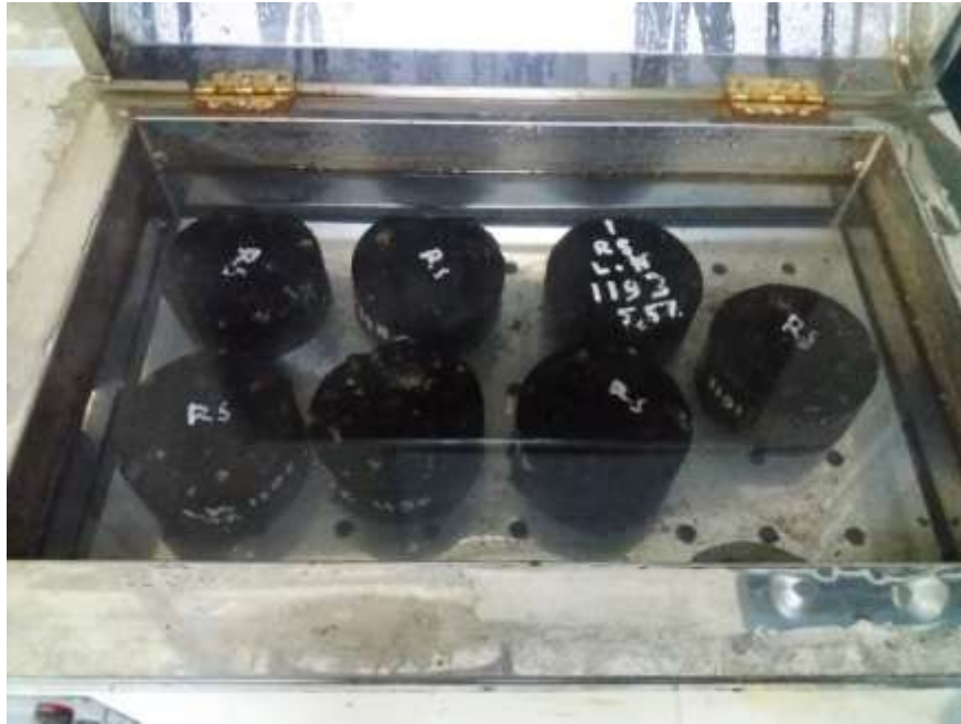
Gambar L15: Proses perendaman benda uji di dalam waterbath dengan suhu 60°C.
