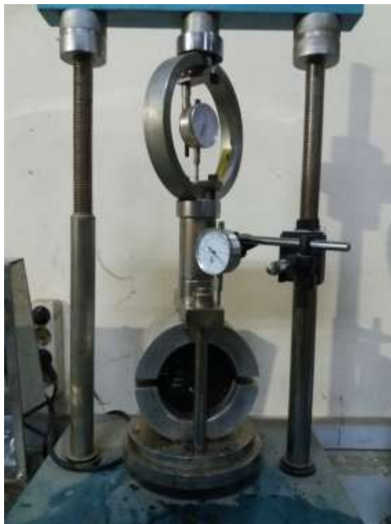
Gambar L14: Pengujian Marshall Test .
