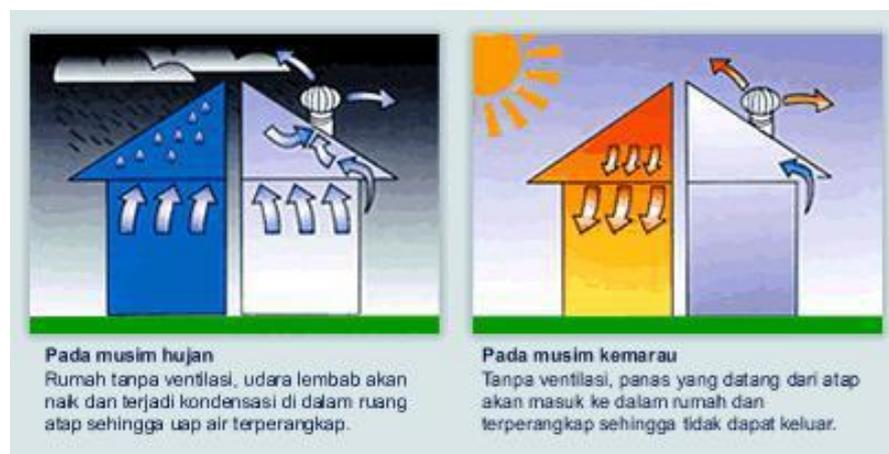
Gambar 2.11 Mekanisme ventilasi dengan menggunakan Turbine Ventilator
