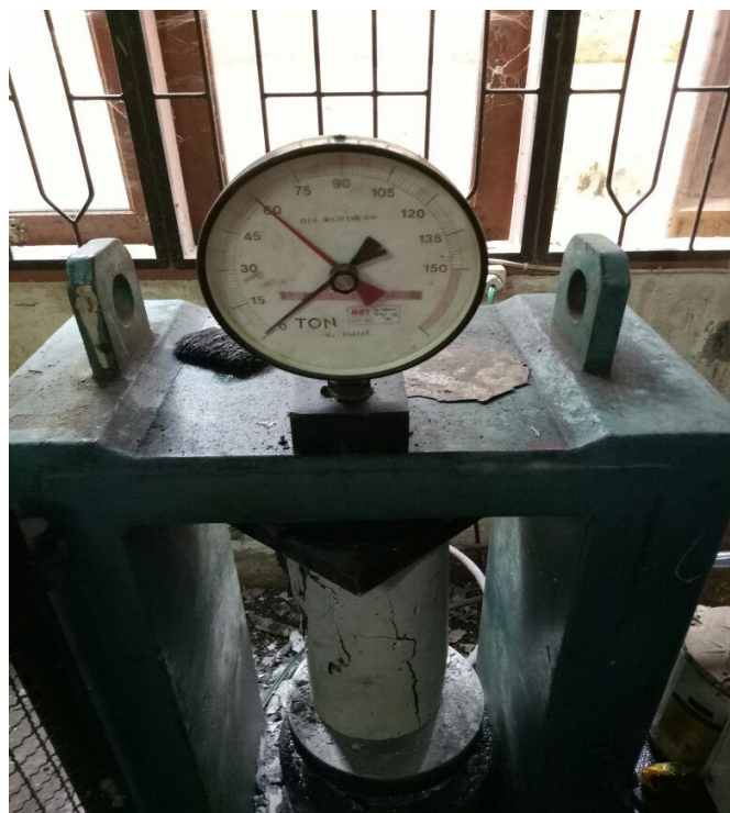
Gambar L12: Uji kuat tekan beton campuran abu serat kult durian 3% 28 hari: 60 T.
