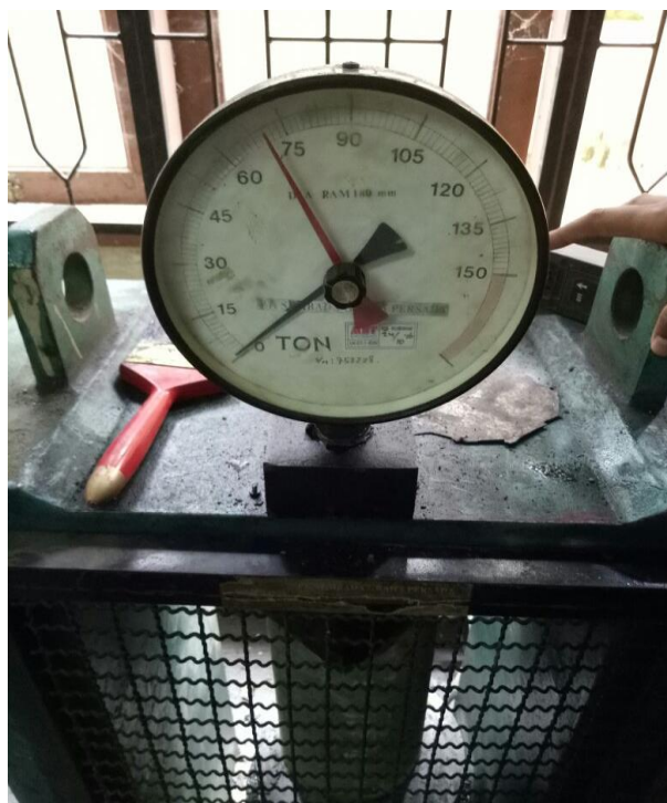
Gambar L13: Uji kuat tekan beton campuran abu serat kulit durian 5 % 28 hari 67,5 T.
