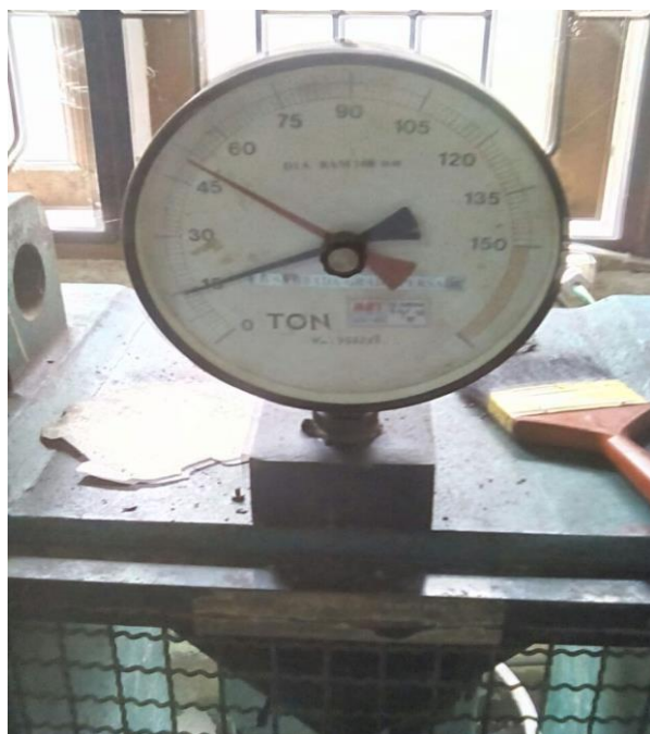
Gambar L11: Uji kuat tekan beton normal 28 hari: 55 T.
