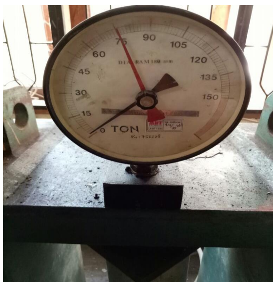
Gambar L14: Uji kuat tekan beton campuran abu serat kulit durian 7% 28 hari 75 T.
