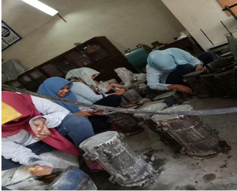
Gambar L9: Proses pencetakan beton selama \pm 24 jam.
