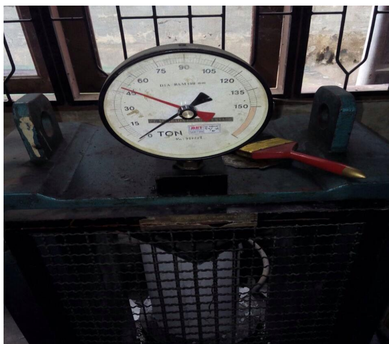
Gambar L14: Uji kuat tekan beton normal 28 hari.
