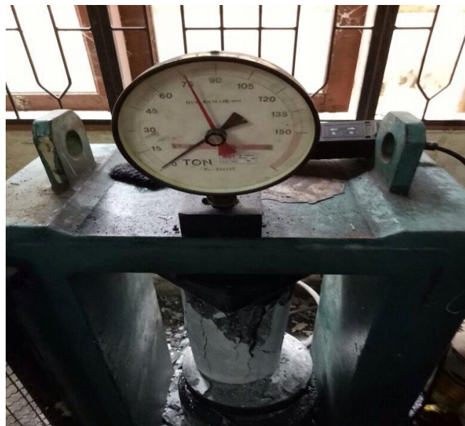
Gambar L16: Uji kuat tekan beton abu sekam padi 10%.
