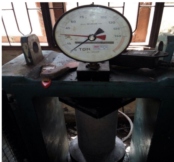
Gambar L13: Beton Setelah diuji Tekan.
