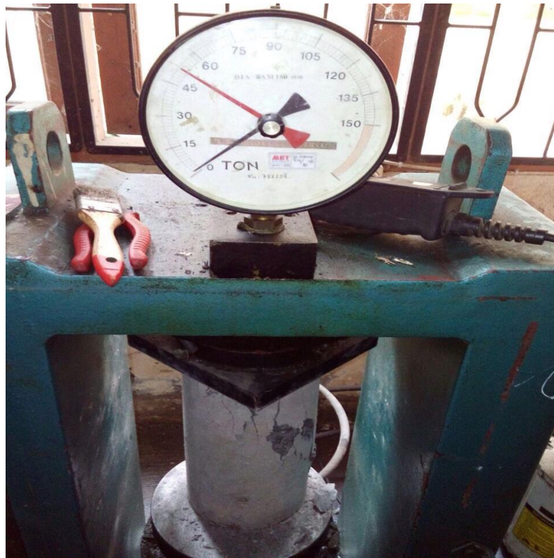
Gambar L15: Uji kuat tekan beton abu sekam padi 5%.
