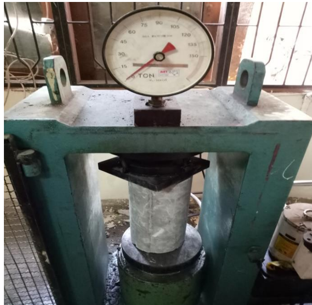
Gambar L12: Beton Sebelum diuji Tekan.
